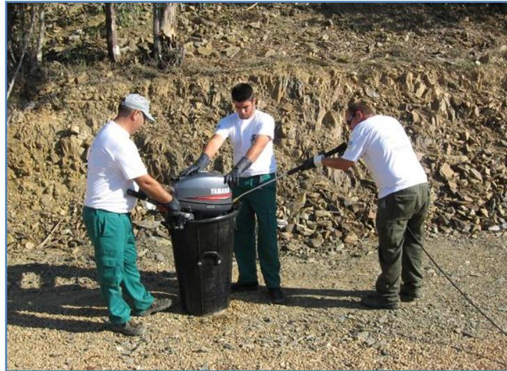
**Ilustración 19. Limpieza de motor. Fuente: Confederación Hidrográfica del Guadiana.**
