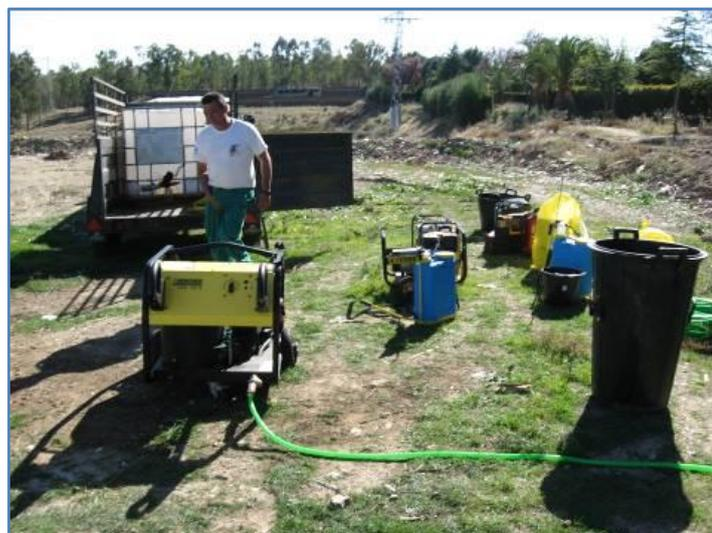
**Ilustración 15. Equipo móvil de desinfección. Fuente: Confederación Hidrográfica del Guadiana.**
